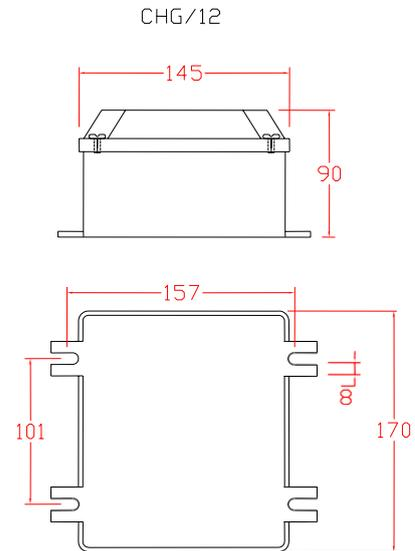
**CUERPO:** Estructura rectangular de aleación de Aluminio fundido por gravedad, tapa con 4 stove bolts galvanizados de  $\varnothing$  3/16". Adosables a superficies planas o para ser empotrados.
